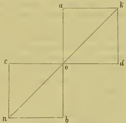
Denken Sie sich aber, es sei das eine Wellensystem gegen das andere um eine viertel Wellenlänge voraus. Es seien  $a b$  und  $c d$  (Fig. 10) wiederum die beiden Schwingungsrichtungen, und es sei durch die Länge der Linien auch zugleich die Amplitude bezeichnet, die Elongation, bis zu
